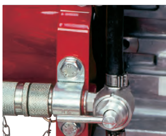
3-Wege Kraftstoffhahn Zum direkten Anschluss eines Betankungssystem.
